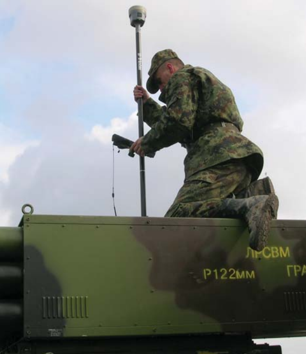
Провера положаја лансера у помоћу ГПС уређаја
